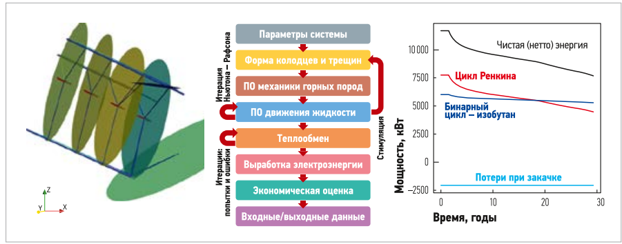
Рис. 2. GeoDT стохастически прогнозирует параметры коллектора, сети потоков, гидравлическое воздействие, производство тепла и электрической энергии, сейсмический потенциал, вызванный закачкой, и, в конечном счёте, оценивает чистую приведённую стоимость
