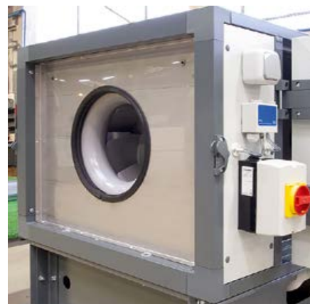
•• Все блоки вентиляторов в установках на базе ВЕРОСА®-620 для данного проекта были оснащены дифференциальными преобразователями давления, которые измеряют перепад давления на входном диффузоре вентилятора и передают измеренные значения в систему автоматики установки.
