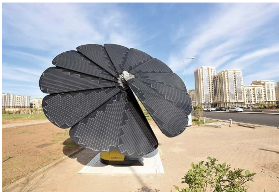
☘ Солнечные батареи в форме цветка на улице Улы-Дала в Астаны в Казахстане обеспечивают «зелёной» электроэнергией уличные светильники со светодиодными лампами
