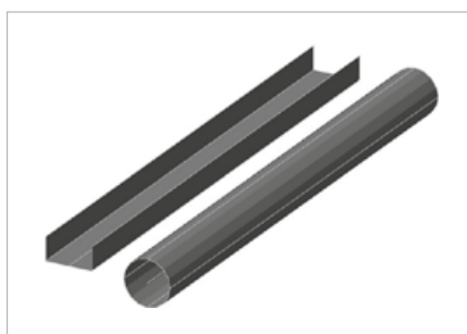
Рис. 1. Примеры прототипов кабельной трассы прямоугольного и круглого сечений
