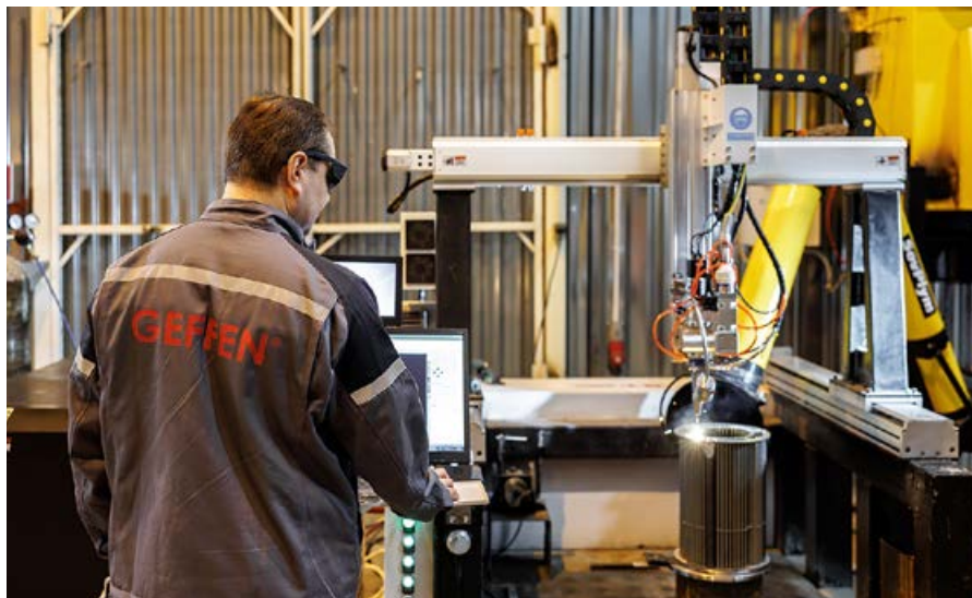
✚ Роботизированная сварка теплообменника на заводе GEFFEN
