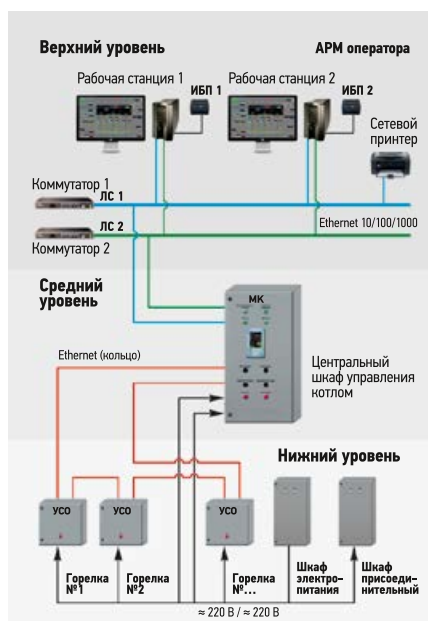
✚✚ Рис. 3. Схема построения управления технологическим процессом для котлоагрегата, оснащённого восемью горелками
