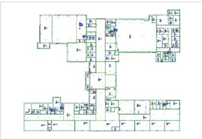
•• Рис. 16. Автоматически расставленные извещатели на первом этаже здания школы (вид сверху)
