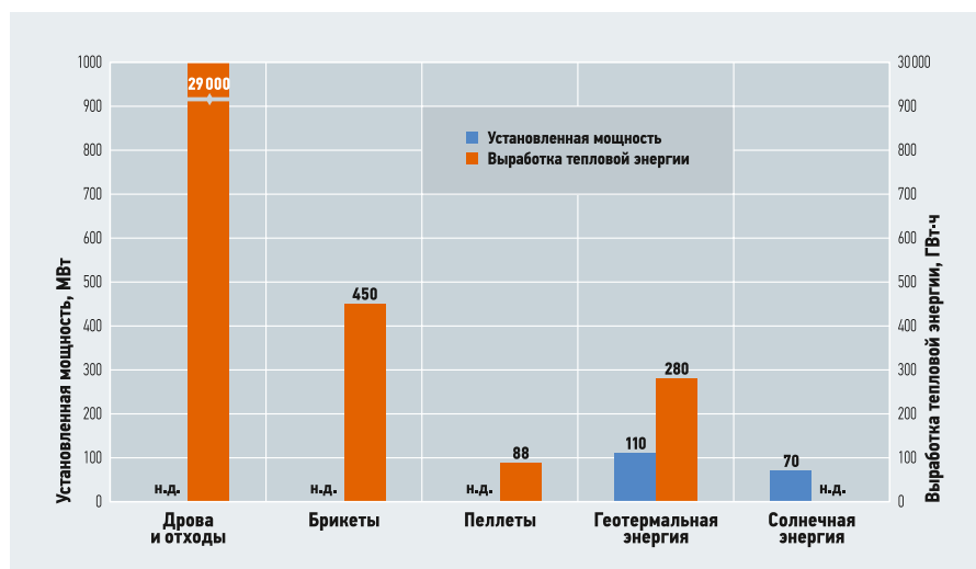
Рис. 5. Установленная мощность и выработка тепловой энергии в 2020 году в РФ на основе ВИЭ
