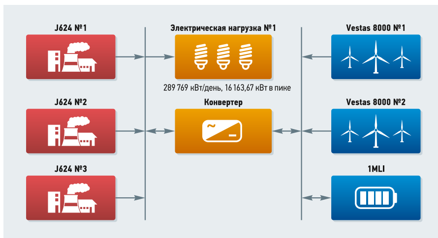
Рис. 4. Схема энергосистемы, смоделированной в Homer Pro
