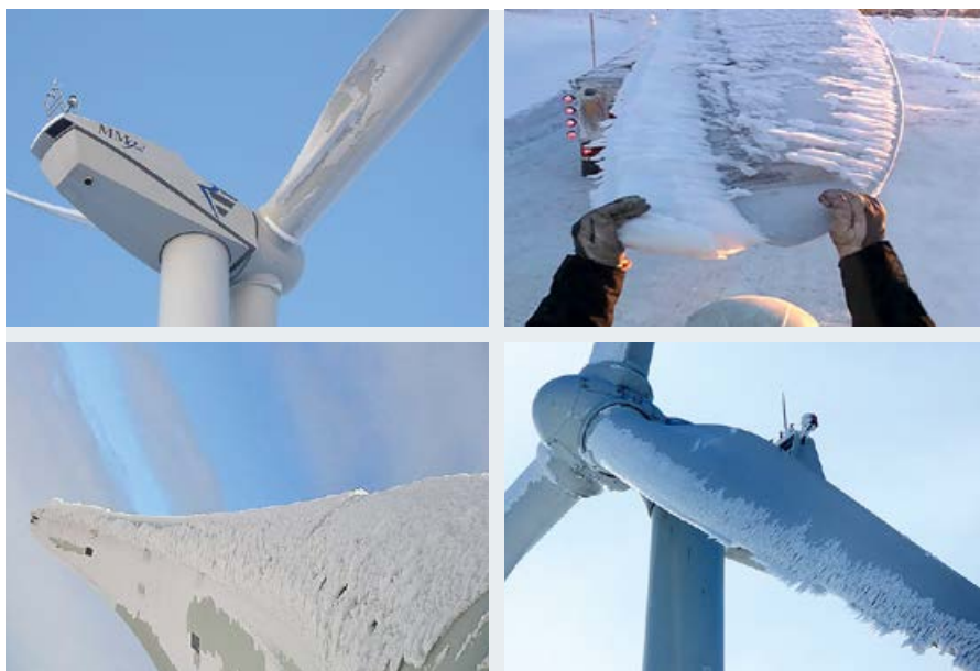
❖ Фото 1. Лопасти без противообледенительной системы
