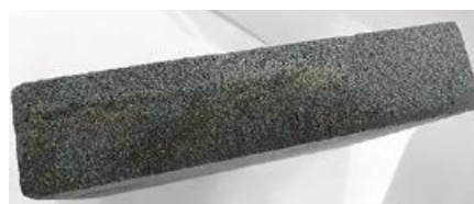
•• Фото 10. Готовый испытательный образец для определения теплопроводности
