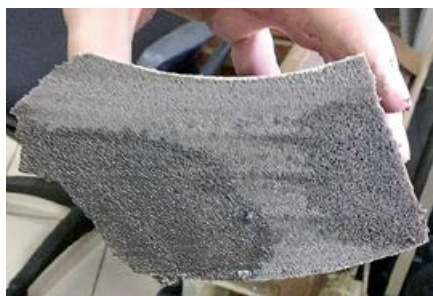
Фото 5. При разрезе материала в сечении наблюдается значительное увлажнение (влага проникла внутрь материала)
