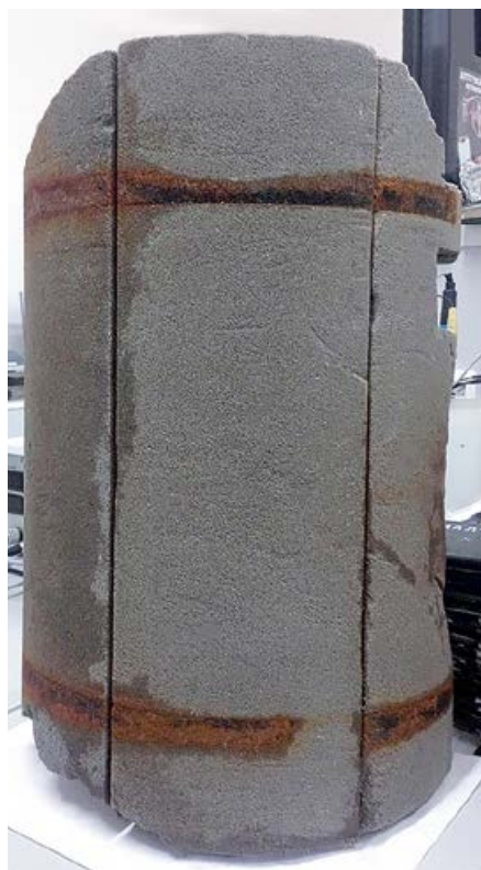
Фото 4. Фрагмент скорлуп из пеностекла в лаборатории (поверхность увлажнена)
