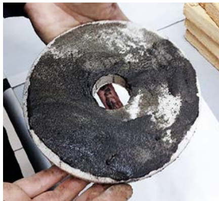
Фото 6. При точении материала на бруске выделялось большое количество влаги
