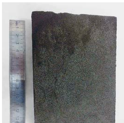
:: Фото 9. Готовый испытательный образец для определения теплопроводности
