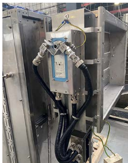
❖ Фото 4. Клапан типа КЕДР® с обогревом стыка лопаток и электроприводов
