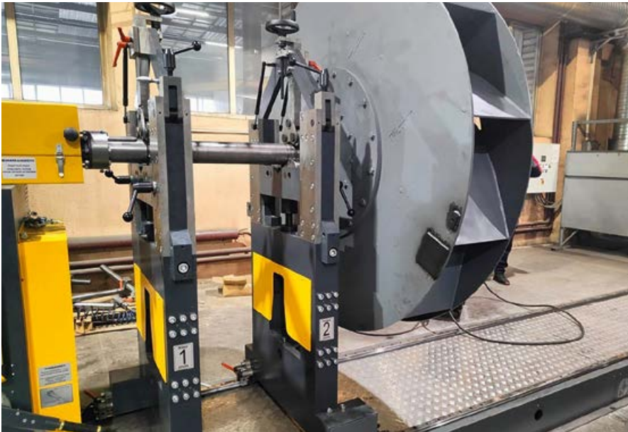
❖ Балансировка рабочего колеса диаметром 1800 мм вентилятора ВИР на станке
