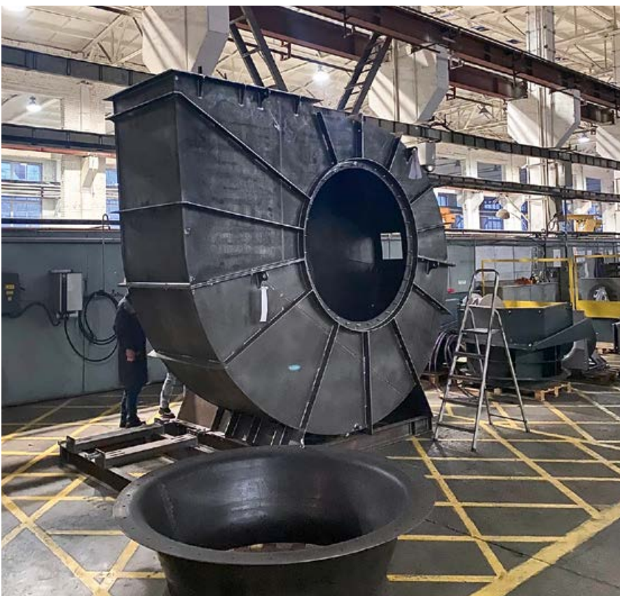
❖ Контрольная сборка корпуса вентилятора ВИР 180-го габарита в цехе
