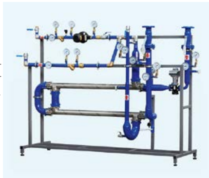
Фото 2. БТП. Блок подключения системы ГВС к закрытым тепловым сетям по одноступенчатой схеме с кожухотрубным теплообменником
