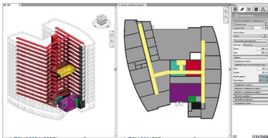
Рис. 2. Схема трассы и определение размеров «технических пространств» на стадии предэскизного проектирования в liNear Desktop
