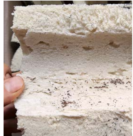
•• Фото 27. Следы ржавчины на образце (гр. III)
