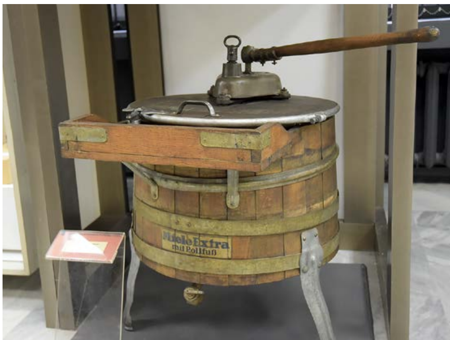
:: Ротационная стиральная машина Miele Extra 1915 года выпуска с ручным приводом. Экспонируется в болгарском Национальном политехническом музее в городе София
