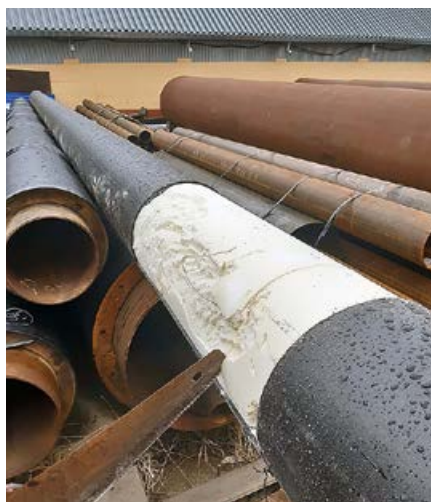
❖ Фото 2. Вскрытие внешней оболочки трубы перед извлечением образцов (гр. IV)
