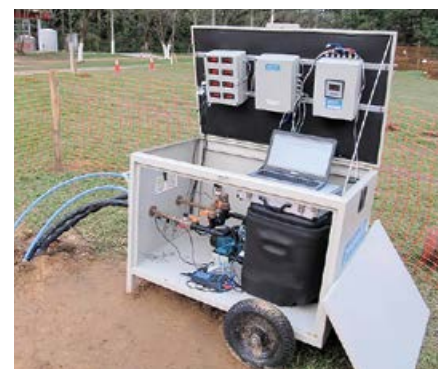
⚡ Установка для определения тепловых свойств грунта на заводе Coca-Cola в Андах
