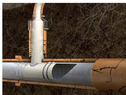
:: Рис. 2. Процесс разрушения трубопровода пневматической системой (1 — старый трубопровод; 2 — оголовник для крепления троса; 3 — конический расширитель; 4 — новый трубопровод; 5 — шланг подачи воздуха; 6 — трос лебёдки; 7 — пневмомолот)
