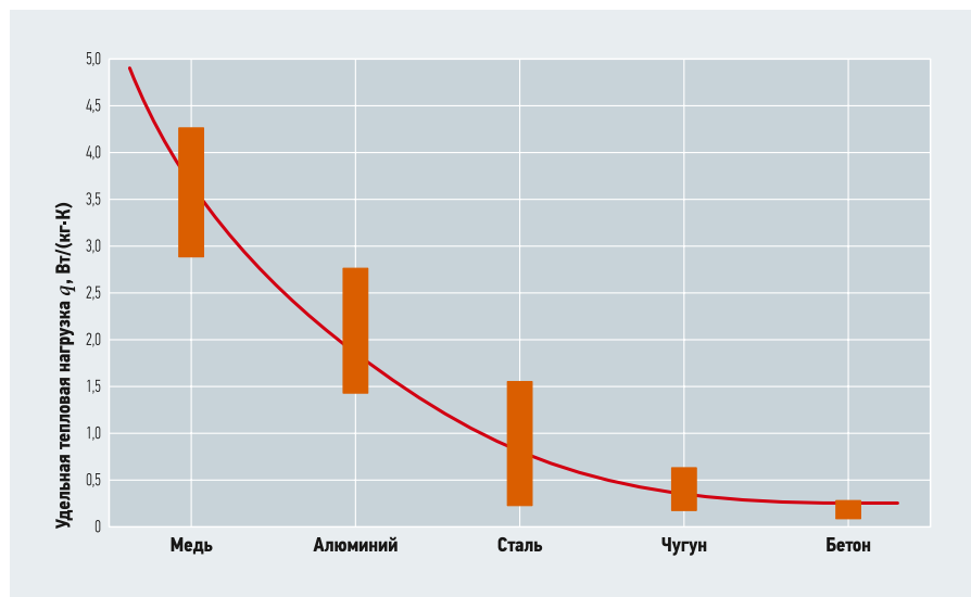
•• Рис. 4. Сравнение отопительных приборов по удельной тепловой нагрузке
