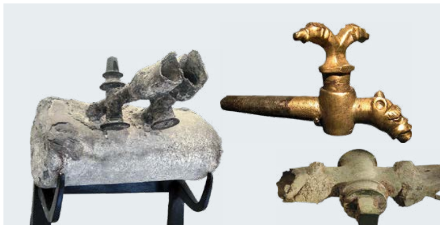
•• Древнеримские клапаны и кран I–III века н. э. из различных бронзовых сплавов
