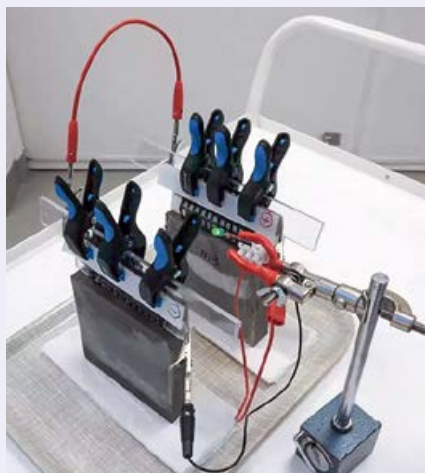
Шведский прототип «бетонного» аккумулятора энергии
