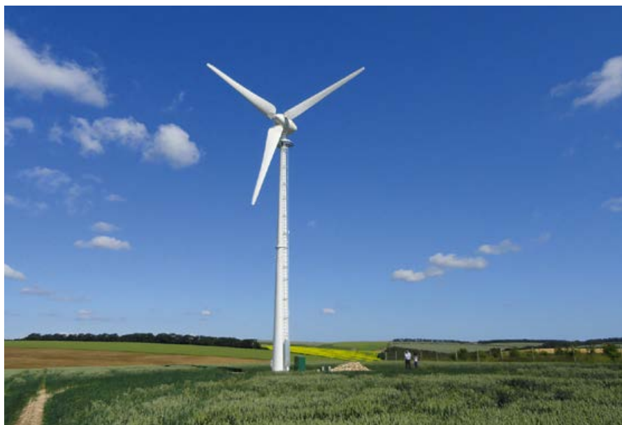
•• Малая ВЭУ Endurance E-3120 (50 кВт) производства компании Earthmill (Великобритания)
