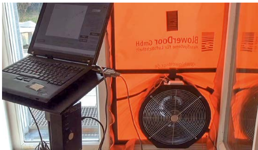
Фото 15. Тест BlowDoor воздухопроницаемости здания
