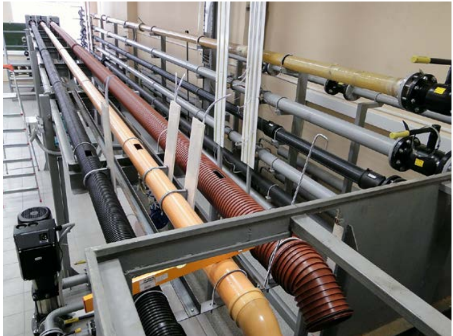
:: Фото 1. Гидравлический стенд с трубопроводами из различных материалов
