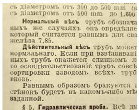
:: Фото 6. Указания по действительному весу труб, сделанные в российском справочнике Hütte от 1916 года (Том I, фрагмент стр. 757)
