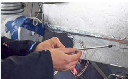
•• Фото 13. Вольфганг Хаспер устанавливает датчики на вентиляционную установку и снимает полученные данные
