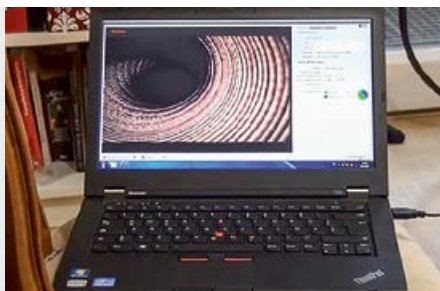
❖ Фото 21. Использование видеокamеры для контроля воздуховодов
