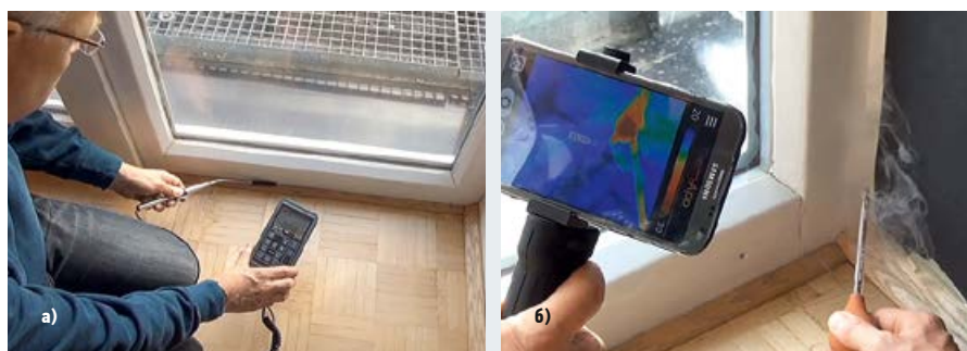
Фото 16. Сёрен Пеппер проводит испытания на воздухопроницаемость (а — измерение скорости ветра с помощью термоанемометра, б — использование театрального дыма и компактного тепловизора для фиксации неплотностей)
