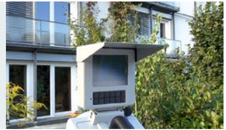
•• Фото 24. Проведение тепловизионной съёмки первого пассивного дома
