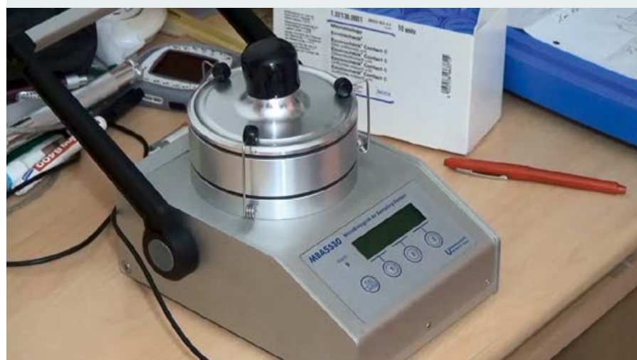
❖ Фото 22. Фильтры класса F8 и концентратор для взятия бактериальных проб из воздуха
