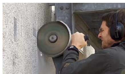
❖ Фото 5. Использование болгарки и горячей струны для взятия образца с фасада здания
