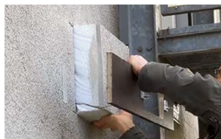
❖ Фото 6. Взятие образца теплоизоляции и временное заполнение ниши минеральной ватой
