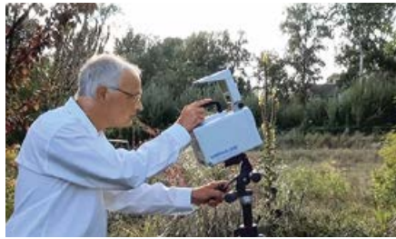
•• Фото 24. Проведение тепловизионной съёмки первого пассивного дома
