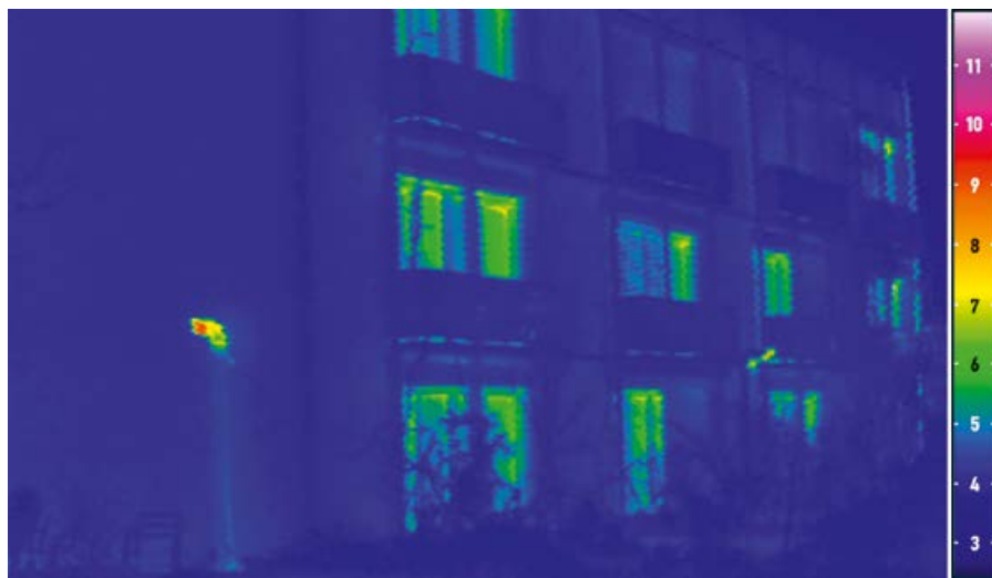
❖ Фото 23. Тепловизионный снимок южного фасада первого пассивного дома
