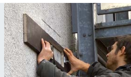
❖ Фото 5. Использование болгарки и горячей струны для взятия образца с фасада здания
