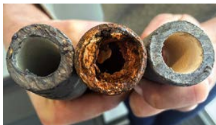
Зарастание труб отложениями (слева направо): обычной свинцовой трубы; стальной трубы; свинцовой трубы, по которой протекала обработанная орто- и полифосфатами умягчённая вода. В Великобритании, например, обработка питьевой воды орто- и полифосфатами подаётся как надёжный способ защиты от солей свинца, поскольку в английских домах до сих пор много свинцовых труб. Однако о возможном вреде подобной «защиты» ничего не говорится.
