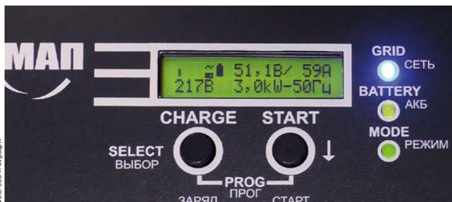
☘ Центральная панель инвертора МАП Hybrid
