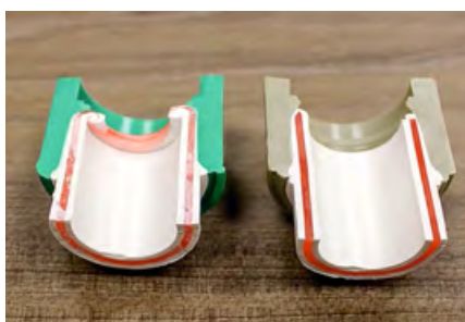
∴ Наглядная разница в качестве соединения трубы и фитинга. Слева — стандартная труба, сваренная обычным способом. Справа — инновационное соединение Lammin®
