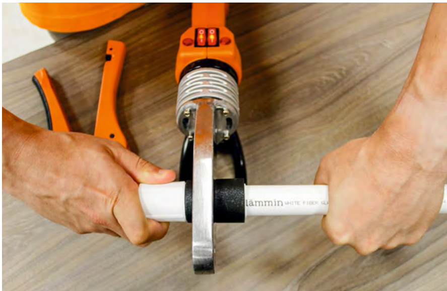
∴ Процесс сварки полипропиленовых труб Lammin®
