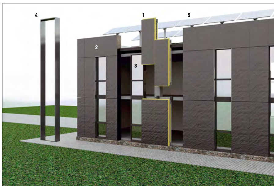
•• Рис. 8. Схема поэлементного монтажа фасада здания (1 — многослойная фасадная панель; 2 — парапетная панель; 3 — витраж; 4 — замкнутая рама; 5 — солнечные батареи)
