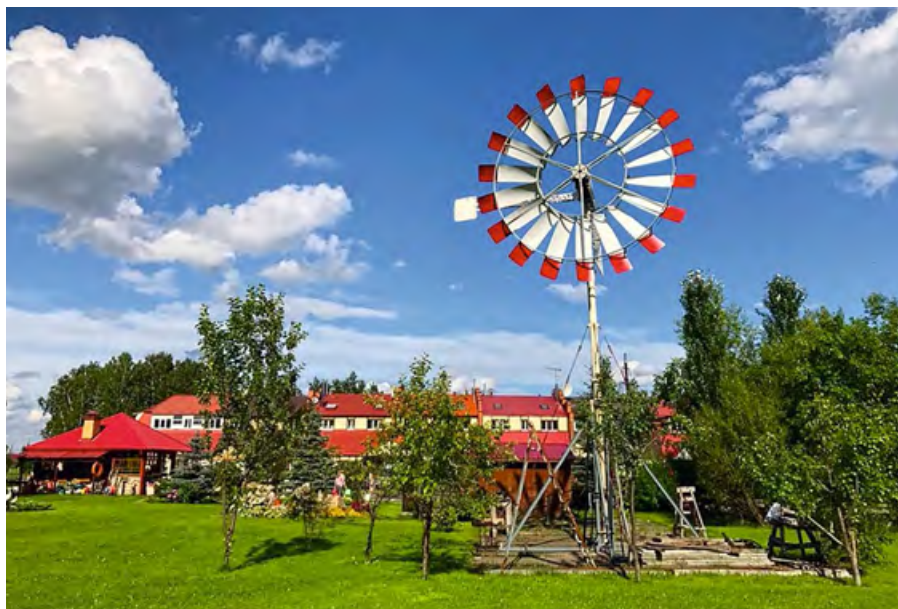
Рис. 2. На прилегающей территории установлено несколько ветрогенераторов (600 Вт), рассчитанных на небольшие скорости ветра
