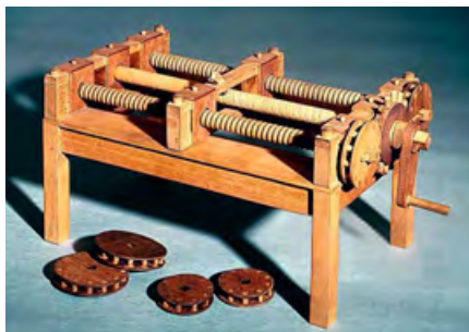
⚡ Модель винторезного станка, выполненная по чертежам Леонардо да Винчи XVI века
