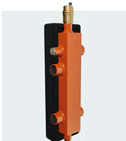
❖ ❖ Рис. 6. Устройство для гидравлической развязки первичного и вторичного контуров в системах отопления и охлаждения, а также удаления воздуха и шлама из системы [расход до 7 м 3 /ч (200 кВт при \Delta t = 25^\circ\text{C} ); рабочая температура до +120 °С; рабочее давление до 6 бар; рабочая среда — вода или смесь с содержанием гликоля до 50 %; автоматический воздухоотводчик для удаления воздуха; сливной кран для удаления шлама; блочная EPP-теплоизоляция]
