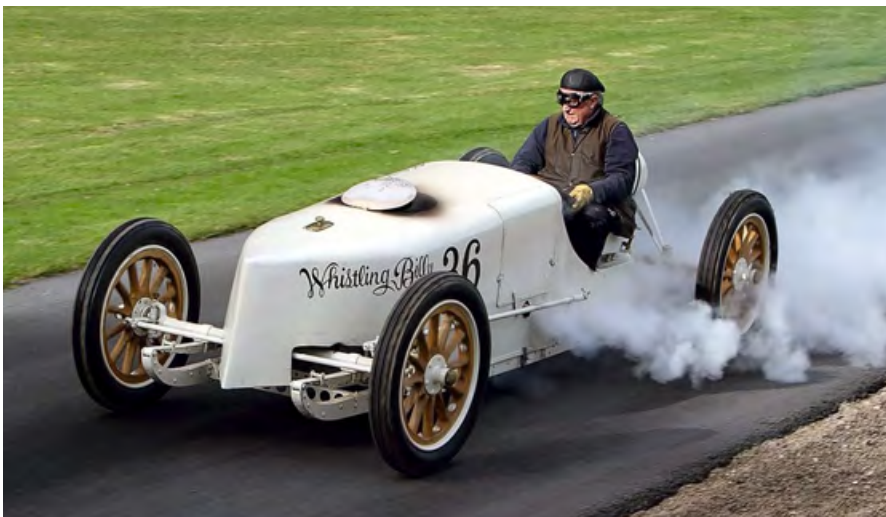
•• Современная точная копия парового гоночного автомобиля Whistling Billy («Свистящий Билли») 1905 года развивает скорость до 160 км/ч (давление пара до 55 атм, топливом служит гексан)
