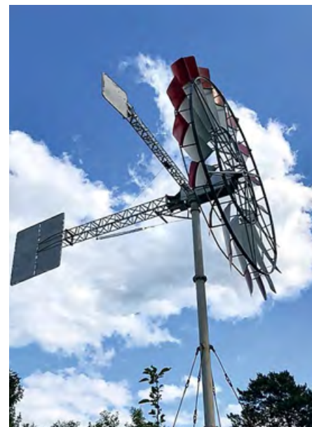
Рис. 2. На прилегающей территории установлено несколько ветрогенераторов (600 Вт), рассчитанных на небольшие скорости ветра
