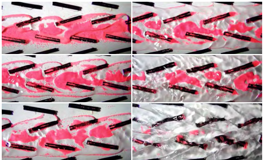
Рис. 4. Визуализация динамики выноса песчаных включений с текстурированной поверхности в зависимости от скорости течения
