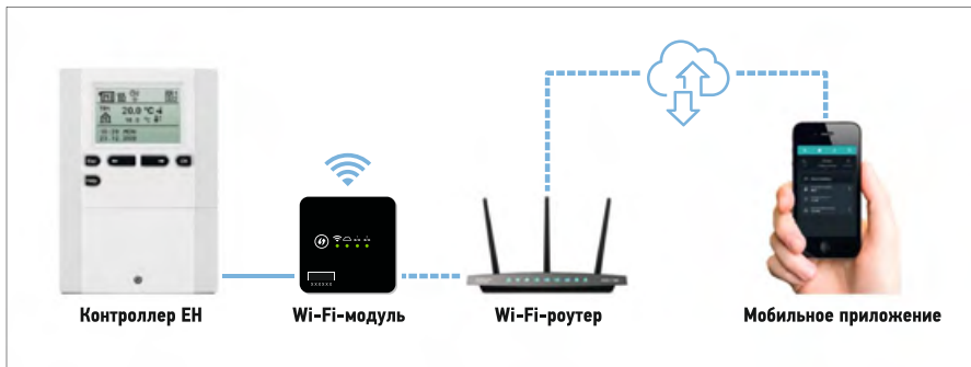
•• Рис. 4. Схема подключения контроллера EH к сети Интернет
