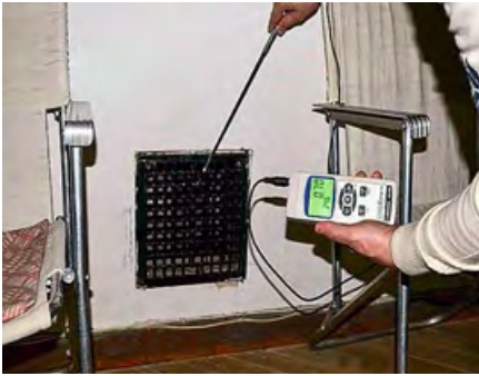
•• Фото 2. Измерение скорости движения воздуха на верхнем сечении воздухораспределителя у воздухораспределительной решётки (коридор, 1-й этаж)
