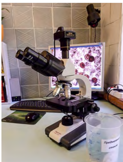
⌘ Фото 11. Микроскоп, видеокамера, ПК и монитор для проведения гидробиологических наблюдений и анализа результатов
