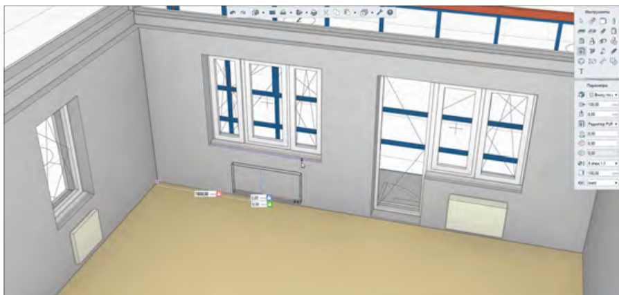
•• Рис. 5. Расстановка отопительных приборов на 3D-виде
