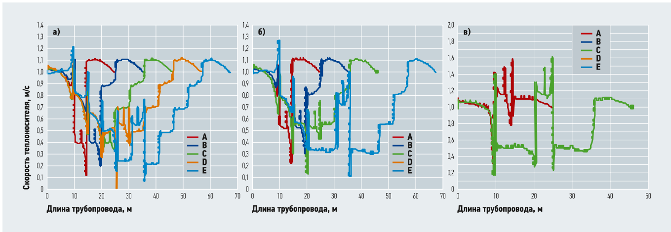
•• Рис. 3. График скоростей тепловой сети на каждом циркуляционном кольце (а — вариант №1, б — вариант №2, в — вариант №3)
