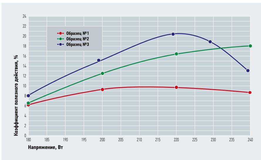
Рис. 2. Графики изменения максимального полного КПД циркуляционных насосов (образцы №1, №2 и №3 на максимальной скорости вращения роторов электромоторов асинхронного типа)
