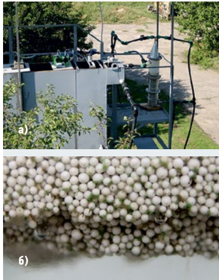
Рис. 5. Предварительный фильтр в составе экспериментального стенда (а) и фрагмент фильтрующей загрузки с задержанными клетками микроводорослей (б)
