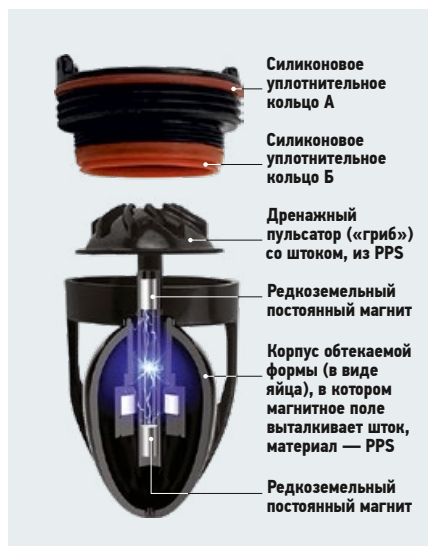
❖ Конструкция магнитного клапана Magdrain
