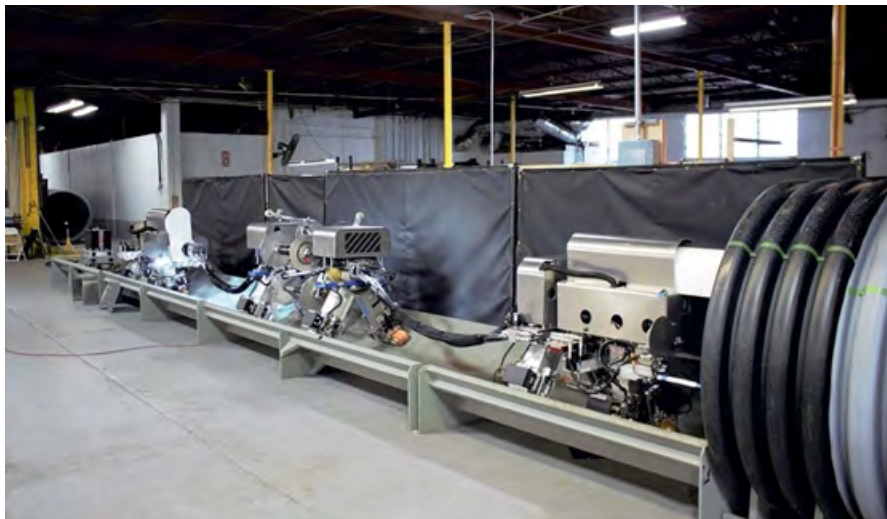
•• Оборудование Structural Technologies для реализации технологии StrongPIPE Hybrid FR
