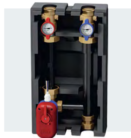
❖ Рис. 1в. Арт. FA 2168 1180RU. Группа быстрого монтажа. В комплект входят: смесительный кран с трёхпозиционным сервоприводом; вставка под насос 180 мм; шаровые краны с термометрами; стальная вставка с обратным клапаном; изоляция из вспененного полиэтилена (PPE)
