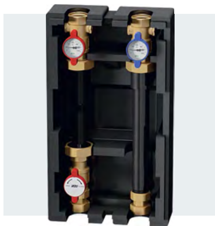
❖ Рис. 1а. Арт. FA 2166 1180RU. Группа быстрого монтажа для высокотемпературных систем. В комплект входят: вставка под насос 180 мм; шаровые краны с термометрами; стальная вставка с обратным клапаном; изоляция из вспененного полиэтилена (PPE)
