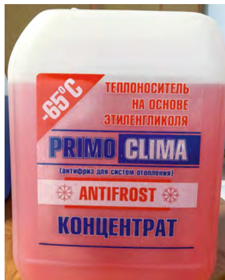
❖ Исследованные теплоносители PrimoClima Antifrost –30°C и –65°C
