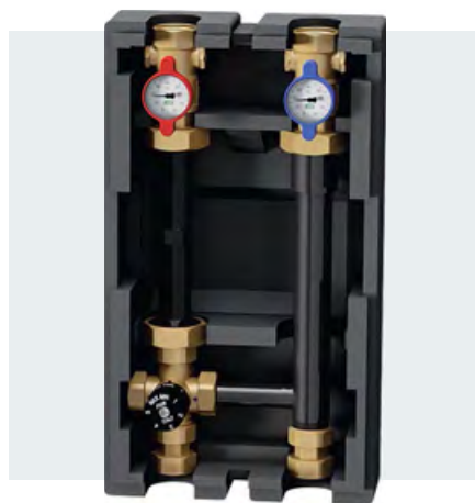
❖ Рис. 1б. Арт. FA 2167 1180RU. Группа быстрого монтажа. В комплект входят: термосмеситель (18–55 °C); вставка под насос 180 мм; шаровые краны с термометрами; стальная вставка с обратным клапаном; изоляция из вспененного полиэтилена (PPE)
