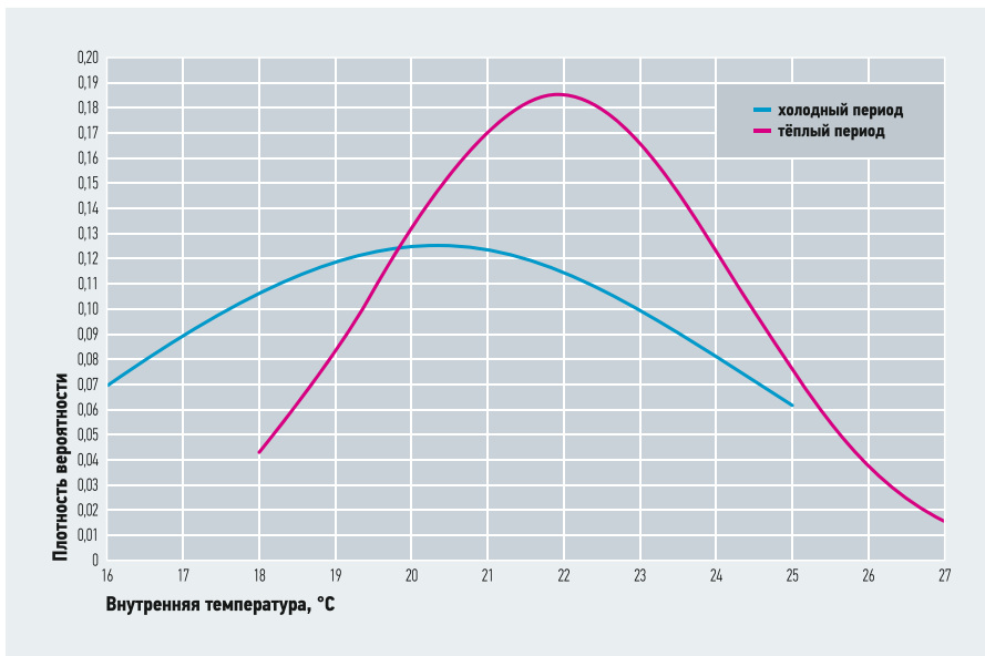
•• Рис. 2. Выбор потребителями офисного здания температуры воздуха на пульте управления летом (охлаждение) и зимой (обогрев)
