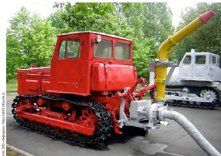
•• Фото. 1. Дальнеструйная навесная дождевальная установка ДДН-70
