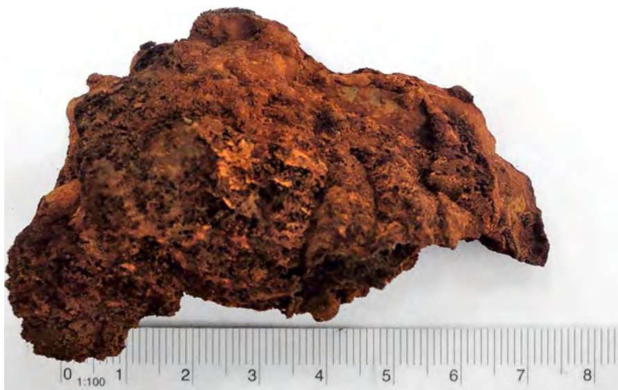
•• Рис. 6. Продукты коррозии, образовавшиеся на внутренней поверхности корпуса (между шаром и корпусом) стального шарового крана
