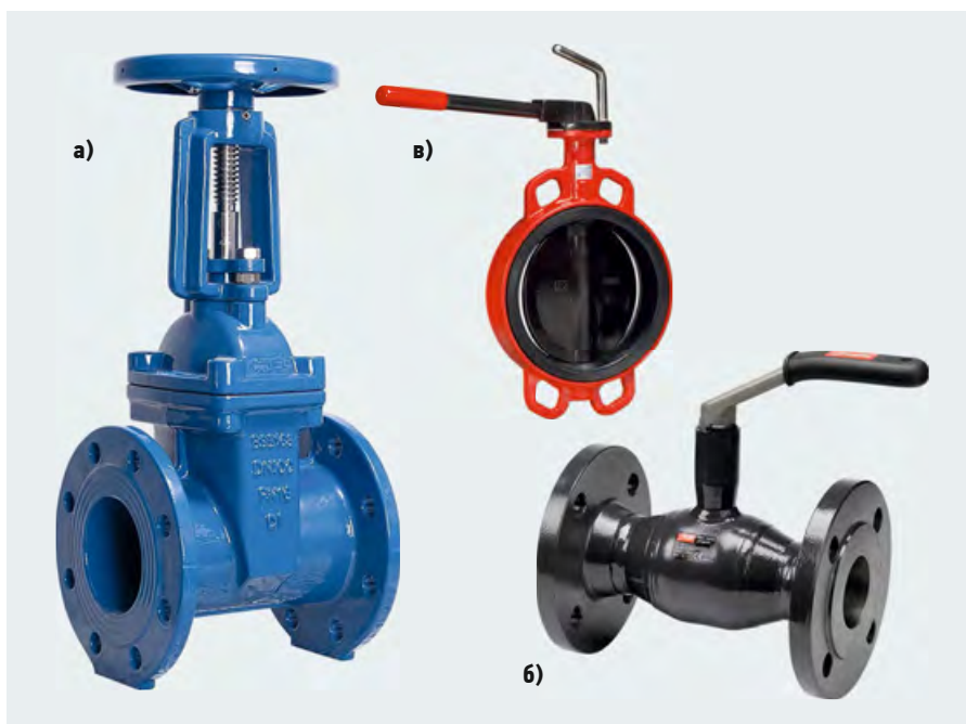
❖ Рис. 1. Примеры запорной арматуры с ручным приводом, применяемой в системах ГВС (а — чугунная клиновидная задвижка Ру10 с выдвижным шпинделем с ручным управлением; б — шаровой фланцевый кран Ру16 с рукояткой; в — межфланцевый дисковый поворотный затвор)
