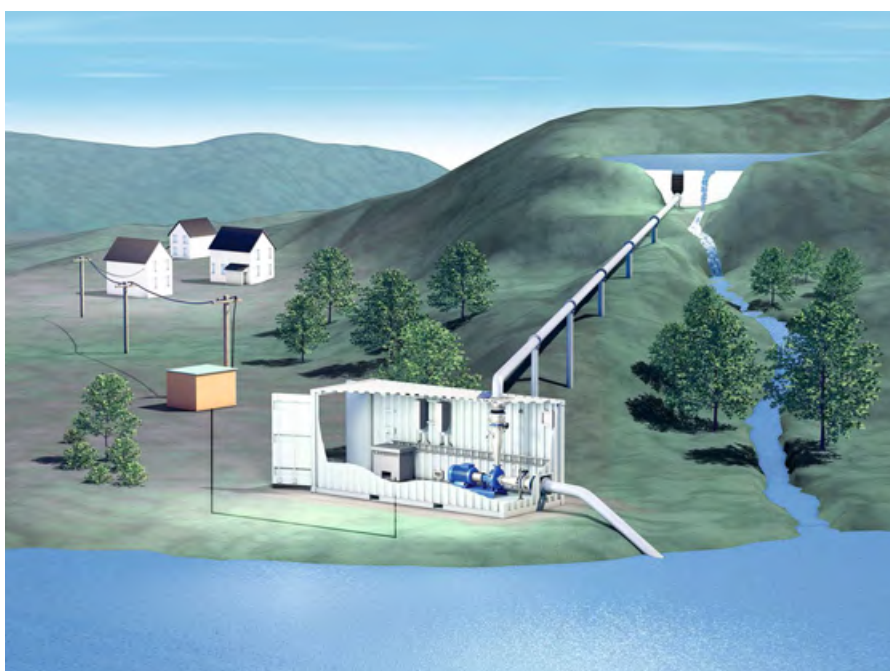
:: Рис. 1. Принципиальная схема работы малой гидроэнергетической установки
