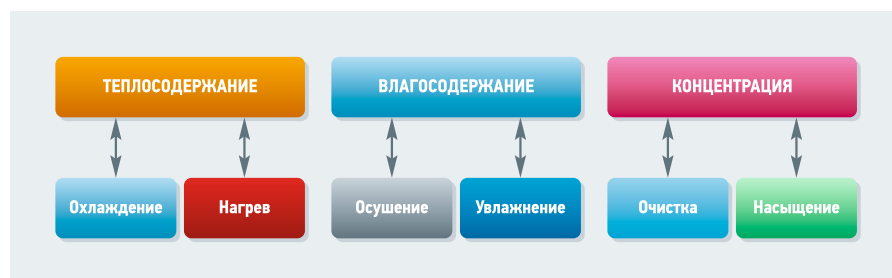
Рис. 1. Процессы обработки воздуха в системах вентиляции и кондиционирования и основные физические параметры, характеризующие направления процесса обработки
