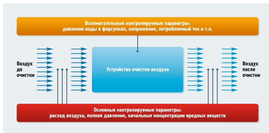
Рис. 2. Принципиальная схема измерения и контроля параметров эффективности устройства очистки воздуха
