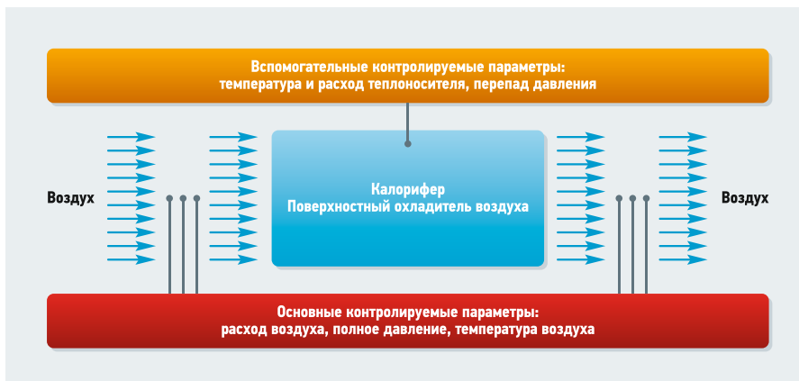
❖ Рис. 4. Принципиальная схема измерения и контроля параметров эффективности устройства нагрева или охлаждения воздуха
