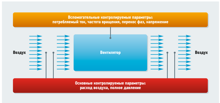
Рис. 8. Схема измерения и контроля параметров эффективности работы вентилятора
