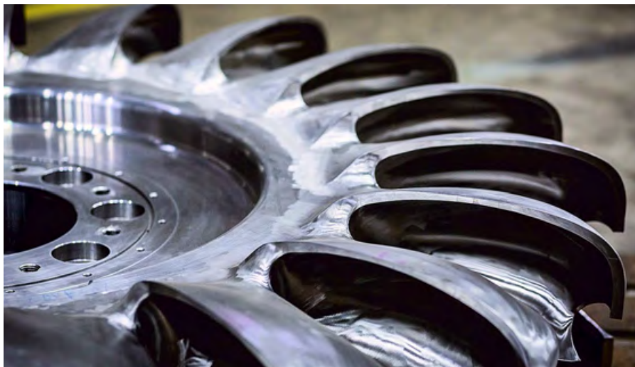
Струйно-новшковая турбина Пелтона как пример многообразия лопаточных машин
