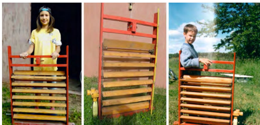
Рис. 2. Простейший лопаточный конвейер, способный служить приводом генератора
