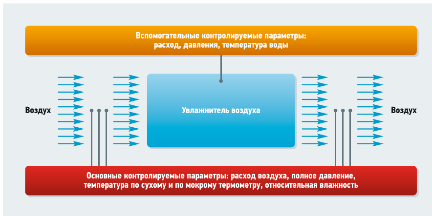
Рис. 6. Принципиальная схема измерения и контроля параметров эффективности работы устройства увлажнения и осушения воздуха
