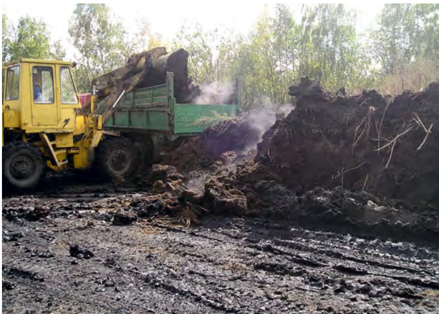
:: Фото 9. Погрузка стабилизированного осадка на площадках обеззараживания
