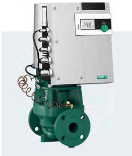
∴ Линейный насос WILO-Stratos GIGA с электродвигателем ЕС и электронной регулировкой мощности в исполнении с «сухим» ротором
