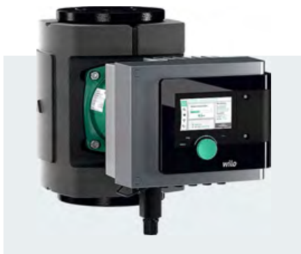
⚡ «Умный» циркуляционный насос Wilo-Stratos MAXO с «мокрым» ротором с электронно-коммутируемым двигателем со встроенной электронной регулировкой мощности
