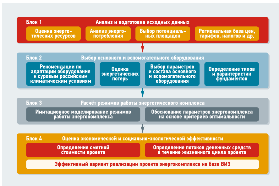
Рис. 1. Блок-схема методики расчёта оптимальных параметров и режимов работы автономного энергокомплекса для энергоснабжения автономных потребителей
