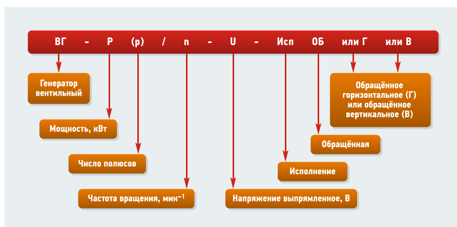
Рис. 2. Структура обозначения генераторов серии «Виндэк»
