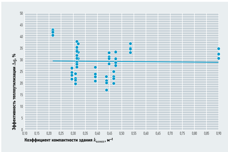
Рис. 2. Зависимость относительной эффективности теплоутилизации от величины k_{\text{комп}}
