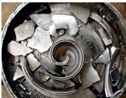
❖ Рис. 6. Заправка жидким хладагентом в газовую магистраль привела к механическому повреждению спирального компрессора
