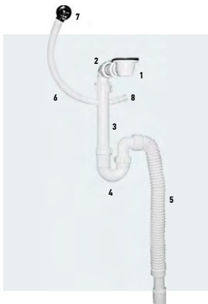
⚡ Рис. 9. Плоский сифон для мойки с переливом (1 — приёмная чаша выпуска; 2 — горизонтальная отводящая труба; 3 — вертикальная труба сифона; 4 — колено сифона; 5 — отводящая труба; 6 — труба перелива; 7 — перелив; 8 — штуцер для подсоединения сливного шланга стиральной или посудомоечной машины)
