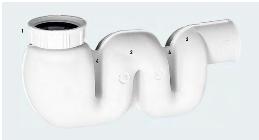
∴ Рис. 3. Трубный сифон для моек и умывальников, выполненный из тонкостенного эластичного материала (1 — уплотнительный узел для монтажа выпуска; 2 — первый изгиб сифона; 3 — второй изгиб сифона; 4 — ребра жёсткости)
