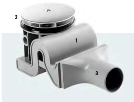
•• Рис. 4. Трубный сифон для душевых поддонов с увеличенной высотой гидрозатвора (1 — прямоугольного сечения колена сифона; 2 — выпуск; 3 — отвод)
