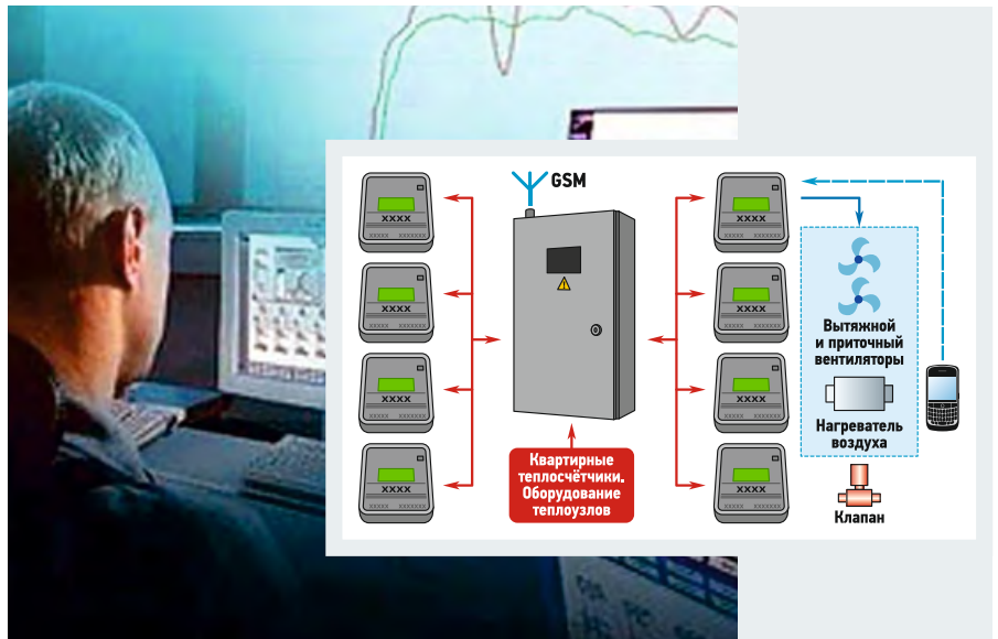
❖ Рис. 10. Система диспетчеризации здания
