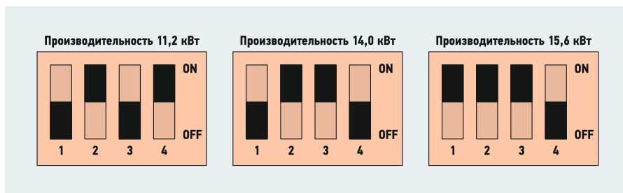
⚡ Рис. 3. Схема установки требуемой производительности в наружных блоках производителя 5
