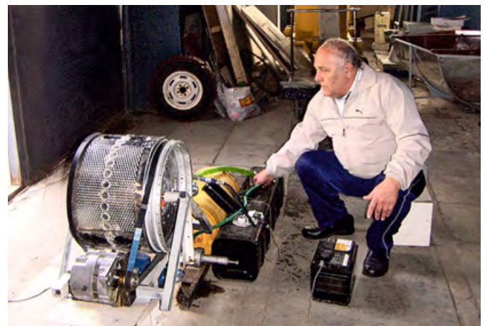
❖ Фото 7. Микро-ГЭС 0,7–1,5 кВт изобретателя Э.Н. Шабалина с автомобильным генератором
