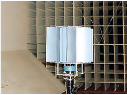
•• Фото 15. Испытание модели вертикально-осевой ветроустановки турбинного типа в аэродинамической трубе НИМК ЦАГИ Т1-Т2
