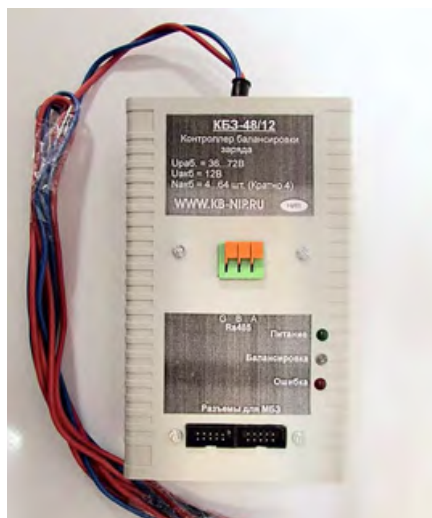
❖ Фото 31. Контроллер балансировки заряда (балансир для АКБ) КБ3-24/12 — разработка компании ООО «НИП»
