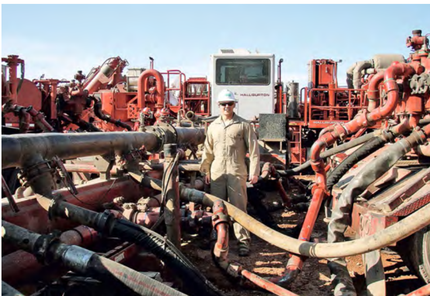
❖❖ Рис. 6. Смешивание воды со специальным гелем для закачки в породу при ГРП
