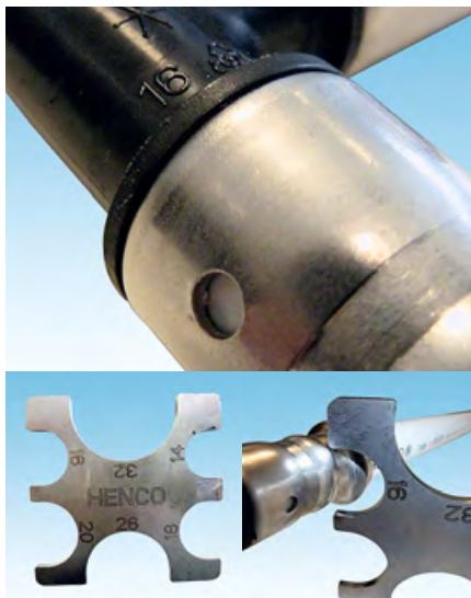
⚡ Проверка соединения калибром Press-Check
