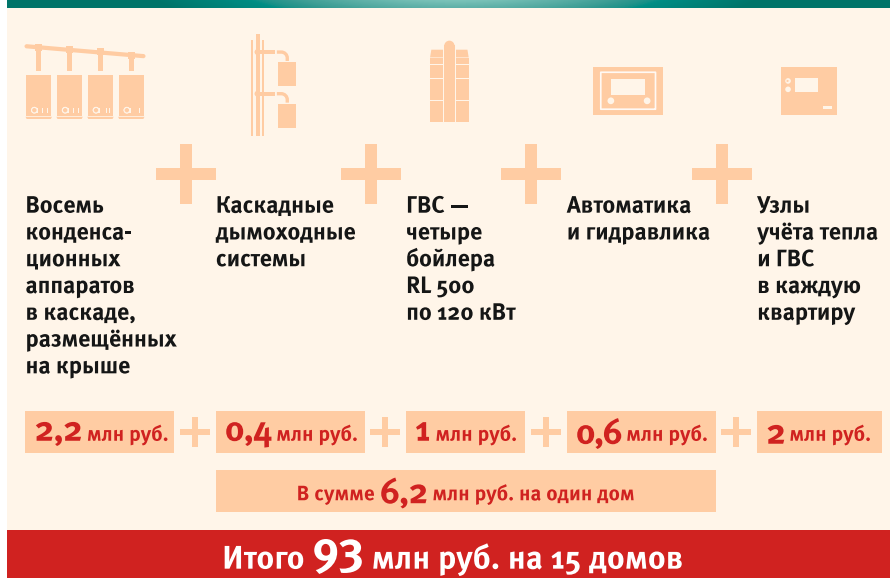
Рис. 4. Крышные котельные на конденсационных котлах
