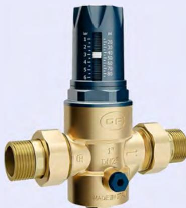
Officine Rigamonti S.p.A. представила новое поколение редукторов давления — Twist PN25. Редуктор давления мембранного типа представляет собой автоматический клапан, снижающий и стабилизирующий давление среды внутри распределительного трубопровода с учётом предварительно заданного значения. Применение данного устройства необходимо, если максимальное статическое давление в любой точке системы водоснабжения может достигнуть или превысить условное, а также в том случае, когда к трубопрово-
