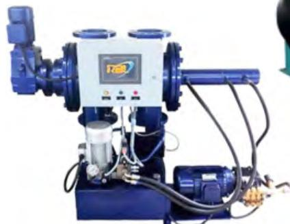
❖ Рис. 1а. Высокотемпературный винтовой парокompрессионный тепловой насос с температурой подачи теплоносителя +85 °С
