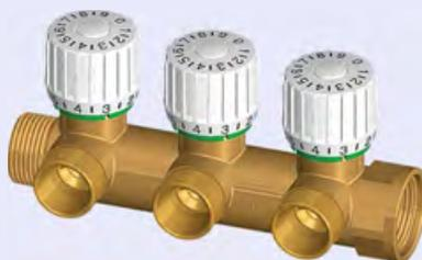
Технические специалисты известного итальянского производителя трубопроводной арматуры FAR Rubinetterie разработали новинку — впервые российским специалистам рынка инженерного оборудования предлагаются коллекторы FAR с возможностью: точной установки требуемого расхода на каждом отводе коллектора по шкале от 0 до 9, что соответствует пропускной способности от 0,09 до 1,2 м<sup>3</sup>/ч; фиксирования выбранной настройки и изменения подачи теплоносителя в выбранном диапазоне; блокирова-
