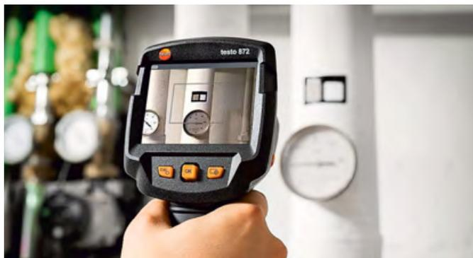
❖ Прикрепите testo ε-marker и снимите объект цифровой камерой тепловизора — и ε, и RTC будут определены автоматически
