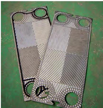
❖ Рис. 3. Пластины разборного теплообменника
