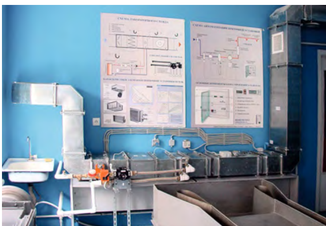
❖ Стенд «Приточная установка»
