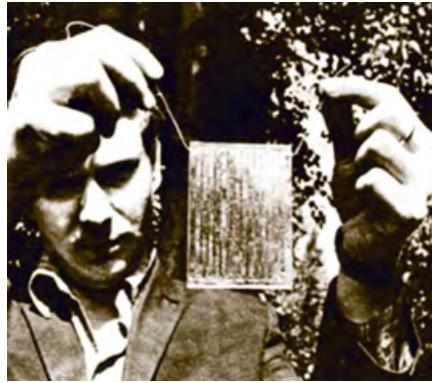
•• Рис. 6. Б.А. Ершов, инженер ВНИИТ, с самым первым образцом матричного солнечного элемента площадью 40 см 2 (1968 год)
