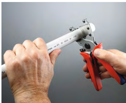
:: Рис. 1. Отрезание трубы при помощи труборезных ножниц
