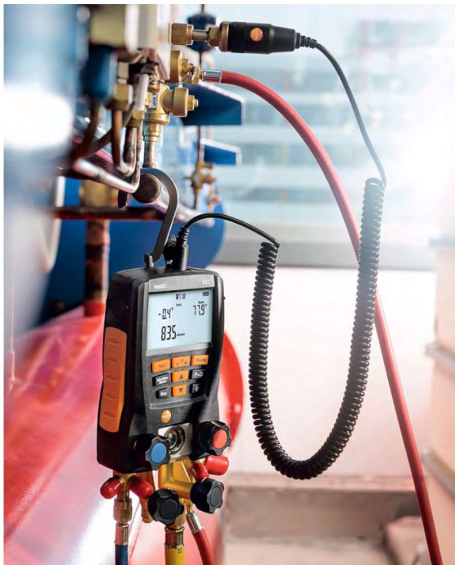
❖ Измерение вакуума с помощью с testo 557
