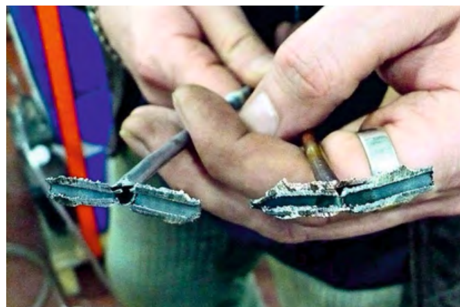
❖ Фото 7. Проверка отсутствия нагара при разрезе соединения
