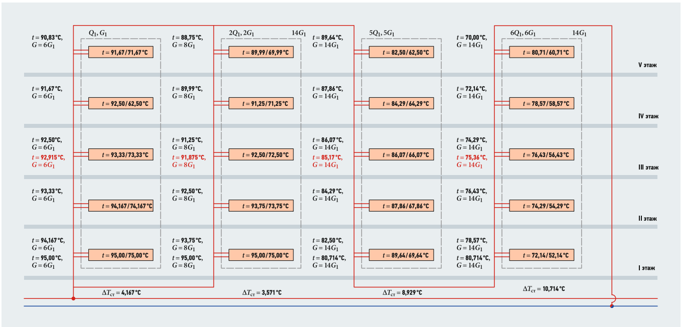
Рис. 5. Однотрубная система отопления повышенной тепловой устойчивости с нижней разводкой, с одиночными стояками различной тепловой нагрузкой и пропуском через них различных количеств теплоносителя
