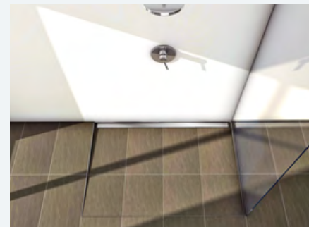
⚡ Фото 3. Установка TECEdrainline вплотную к стене с декоративной панелью steel II (для слива достаточно уклона к стене 1%)
