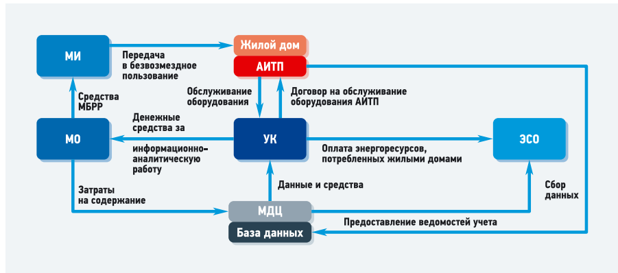
Рис. 2. Структурная схема функционирования системы учета и мониторинга тепловодопотребления (МО — муниципальное образование; МИ — муниципальное имущество; ЭСО — энергоснабжающая организация; МДЦ — муниципальный диспетчерский центр; УК — управляющая компания; АИТП — автоматизированный индивидуальный тепловой пункт)
