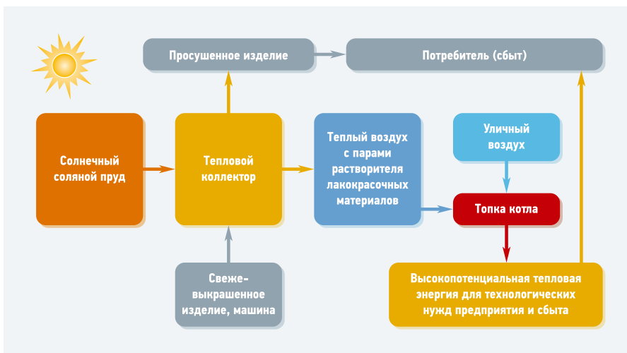
● ● Рис. 5. Схема интегрированного участка по сушке изделий после покраски (на базе солнечного соляного пруда; дополнительно надо учесть, что при испарении в процессе сушки, например, 1 кг каменноугольного сольвента, и при сжигании его паров в топке котла вместе с основным топливом, дополнительно будет вырабатываться до 10–12 кВт·ч тепловой энергии, без учета повышения ее выработки за счет того, что воздух из теплового коллектора поступает в топку котла подогретым)
