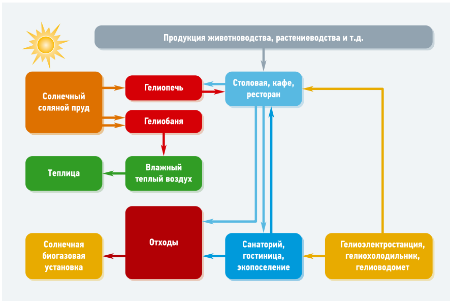
Рис. 2. Схема интегрированного комплекса для проживания и отдыха (на базе солнечного соляного пруда и котлована со льдом и талой водой)
