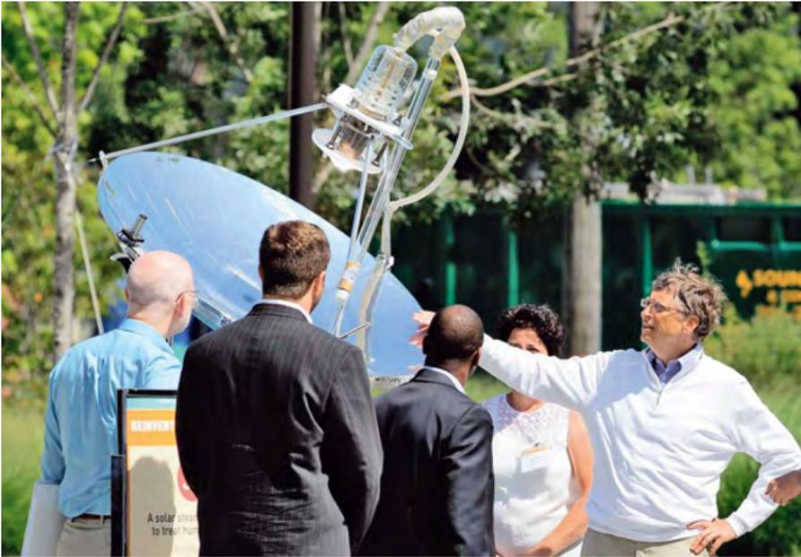
Конкурсный проект туалета, с помощью солнечной энергии производящего водород и электрическую энергию из отходов
